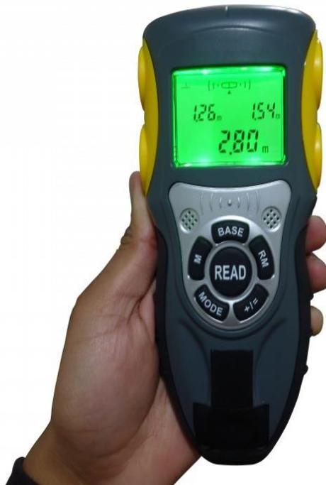
Bidireccional metro de distancia ultrasónico con intervalo de medición de hasta 32m
