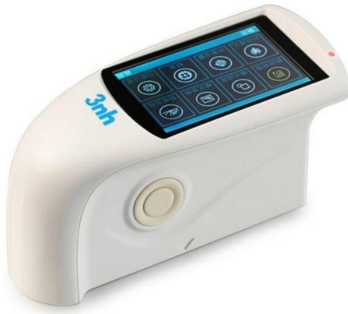
Características barata medidor de brillo HG60 con ángulo de 60 °, fabricados de acuerdo con ISO2813 y GB T / 9754. También es compatible con las normas internacionales de ASTM D523, ASTM D2457. HG268 se ajusta a JJG696 primer requisito medidor de brillo de la clase trabajadora, que corresponde con el CIE 1931 (2 °) con fuente de luz CIE C.
