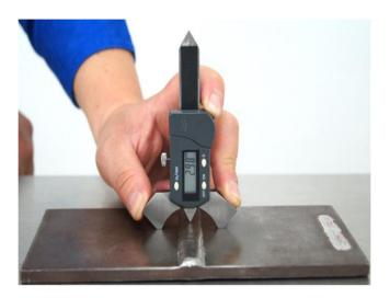
Ahora realizaremos la medición de la garganta en una junta tipo filete.
