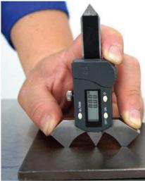
Una vez realizado este ajuste se coloca el medidor sobre la soldadura, ajustando la escala hasta que toque la parte superior del cordón de soldadura y los extremos en el metal base. De manera automática al ajustar la escala nos dará el valor correspondiente al tamaño del cordón.
